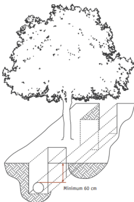
Rysunek 1. Schemat tunelowania — od miejsca, w którym zaczynają się korzenie o 2,5 cm średnicy, roboty ziemne powinny być wykonywane pod nimi techniką tunelową
